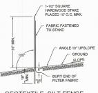
GEOTEXTILE SILT FENCE
